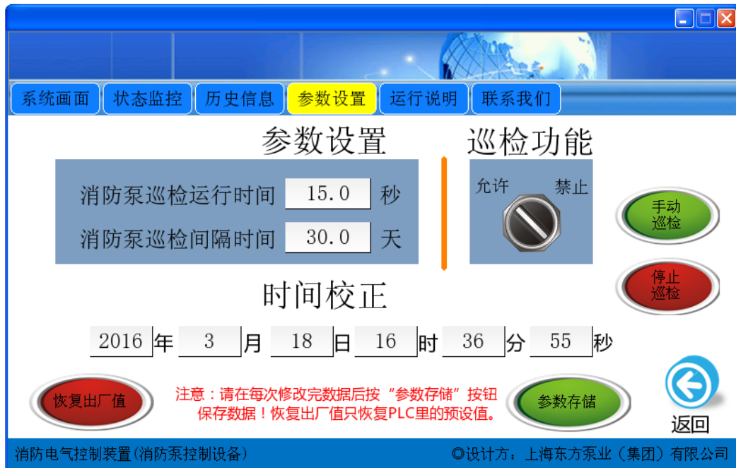
图 32-2 配有消防泵自动巡检控制设备
